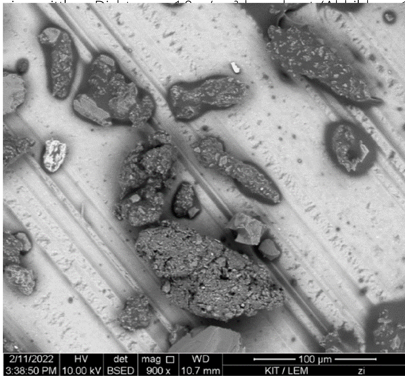
Abbildung 1: Rasterelektronenmikroskopische Aufnahme von TRWP von einem Reifenabriebteststand (@ KIT)
