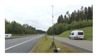
Wenn eine ausreichen große Anzahl von Fahrzeugvorbeifahrten aufgenommen werden, kann eine statistische gut abgesicherte Einfügedämpfungen des Diffraktors an den Mikrofonpositionen ermittelt werden.
