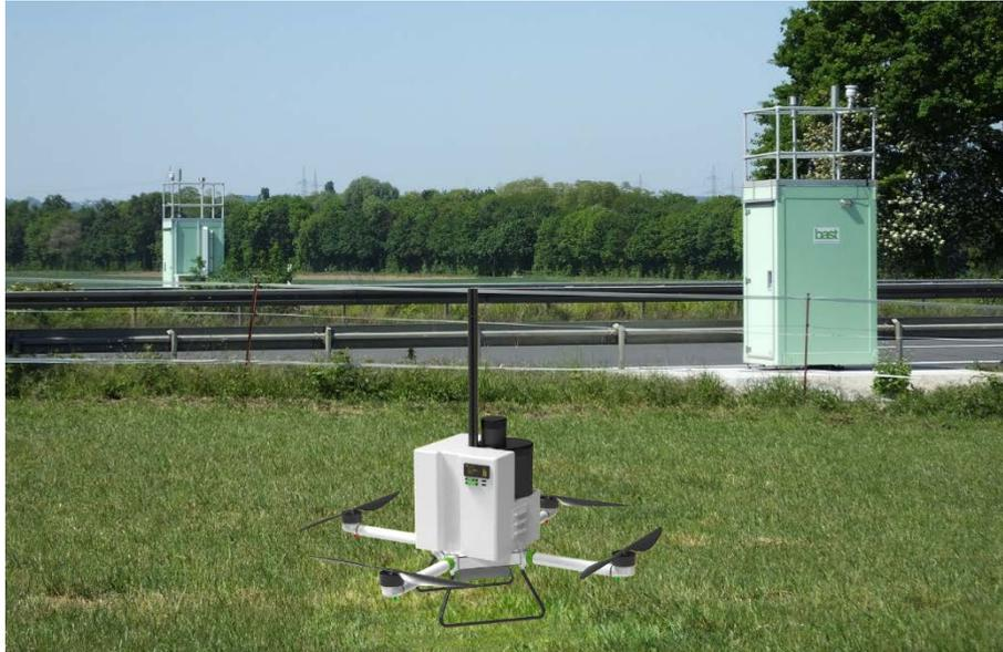
*Abbildung 1: Illustration des Prototyps der Schadstoff-Drohne (Leichtwerk Research GmbH) am Messquerschnitt A555*
